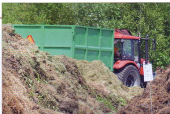
Svoz bioodpadů traktorem s přípojitelným nosičem kontejnerů
