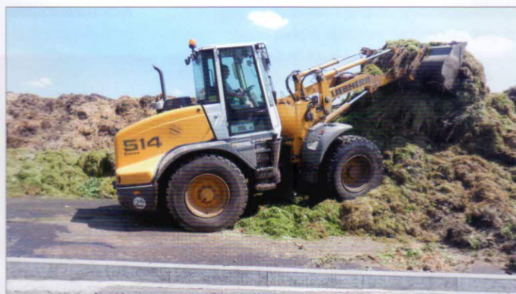
Manipulace se surovinami – kolový nakladač LIEBHERR 514 STEREO (72 kW) s lopatou 1,5 m 3
