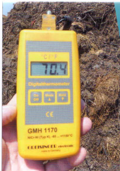
Monitoring – digitální teploměr GMH 1170 s délkou tyčové sondy 2 m a rozsahem měření -65 až +199 °C
